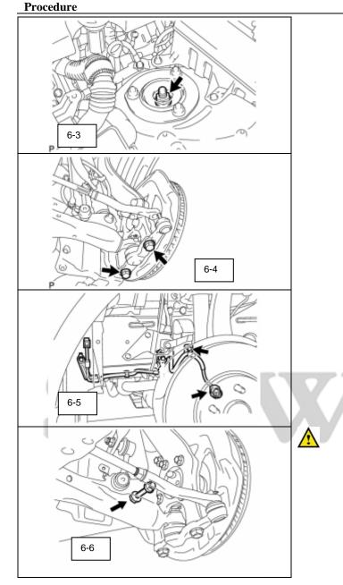
(d) Now fully tighten the new shock assy lock nut. (Fig 6-3)
