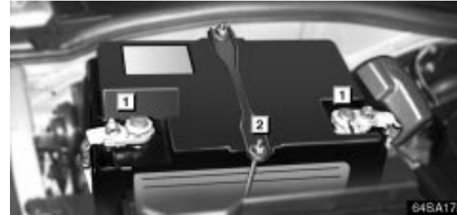
► 1 Terminals 2 Hold-down clamp
