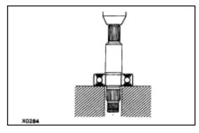
(d) Using a press, press in a new bearing.
