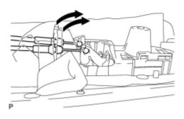
(d) Disconnect the 2 cables from the inside handle.
