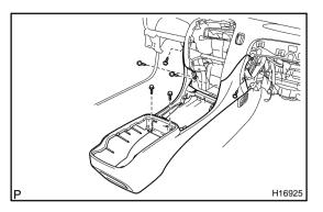
(d) Remove the 2 bolts, 4 screws and console box.
