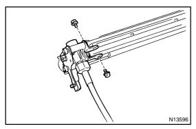
22. REMOVE SLIDE MOTOR HOUSING ASSEMBLY
