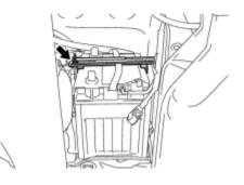
(d) Remove the battery clamp.
