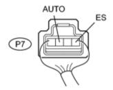
(d) Reconnect the rain sensor connector.
