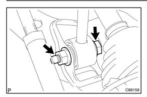
(d) Remove a bolt, the nut and the washer.
