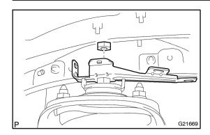
(d) Install the bracket with a nut.
