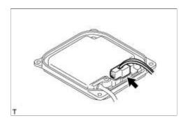
(d) Disconnect the connector and ECU.
