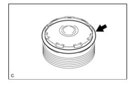
(d) Remove the O-ring from the rack guide spring cap.
