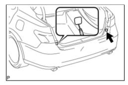
(d) Using a screwdriver, open the 2 rear bumper plates.
