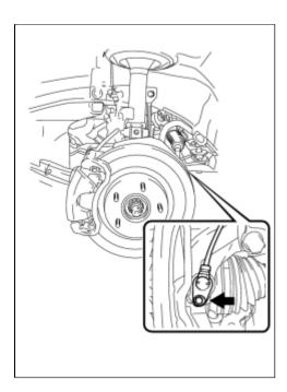
(d) Remove the bolt and the front speed sensor.
