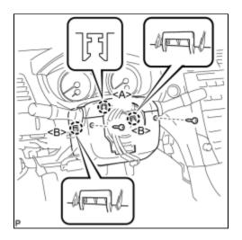
(a) Engage the claw <A> and install the upper steering column cover.
